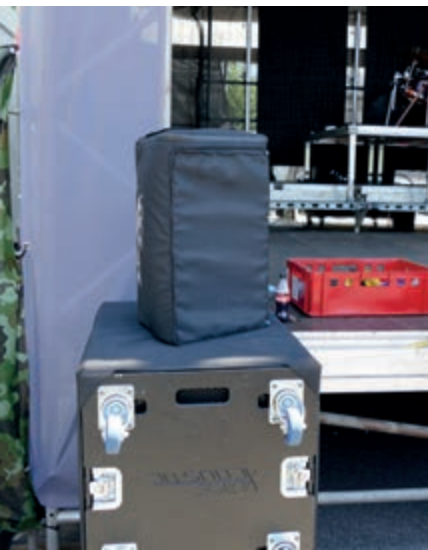
Die Vorderseite der Modular10 Schutzhülle ist wasserfest und laut Hersteller dennoch schalldurchlässig
